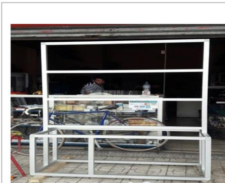
**Figura 3:** Estructura del tablero didáctico de controles eléctricos.
