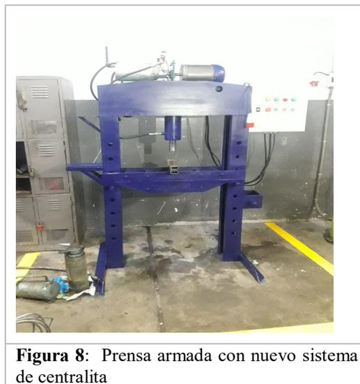
**Figura 8:** Prensa armada con nuevo sistema de centralita
