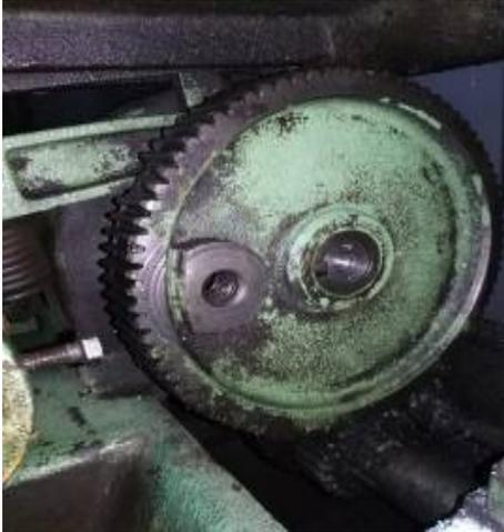
**Figura 3.** Reparación de rueda dentada.
