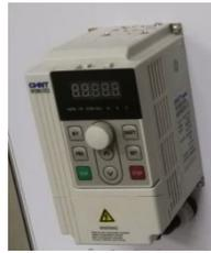
**Figura 5:** variador de frecuencia digital que se encuentra en el módulo #9
