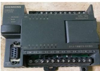
Figura 16. PLC S7 – 200 CPU 222 AC/DC/Relé.
