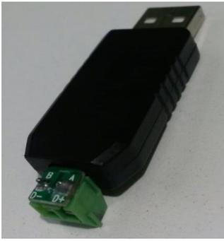
Figura 17. Convertidor RS485-USB.
