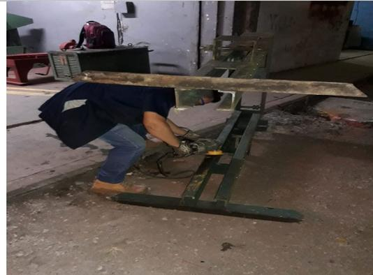
**Figura 5:** Pulido de estructura de prensa para posterior colocación de fondo base para pintura de acabado
