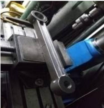
**Figura 2.** Fabricación del brazo de excéntrica.
