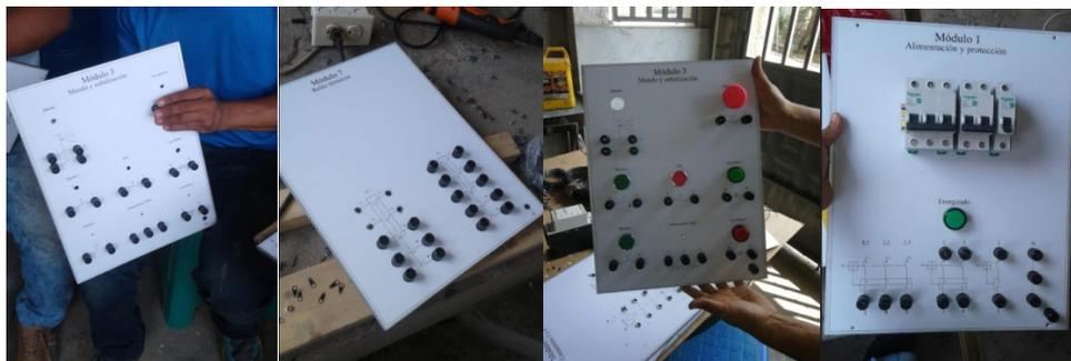
Figura 5. Colocación de los jacks hembra y de los elementos
