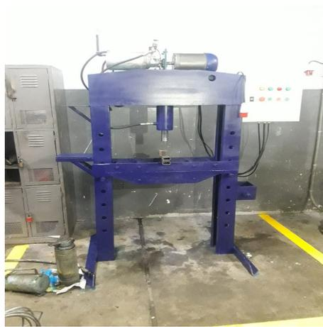
**Figura 8:** Prensa armada con nuevo sistema de centralita
