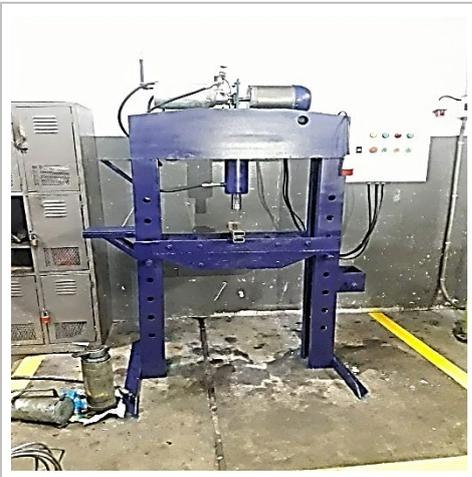
**Fig. 4:** Prensa repotenciada con nuevo sistema de centralita.
