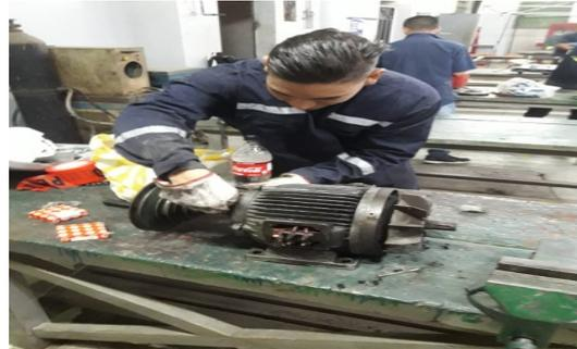
**figura 2B:** cambio de rodamientos
