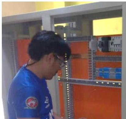
Figura 6.-Montaje de elementos eléctricos de fuerza
