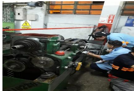
**Figura 4A:** Desmontaje de carro longitudinal
