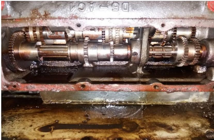
**Figura 2:** Desmontaje de caja Norton.
