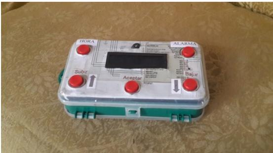
Figura 14 Prototipo Dispensador de pastilla Electrónico
