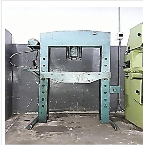
**Fig. 3:** Estado inicial de prensa hidráulica.
