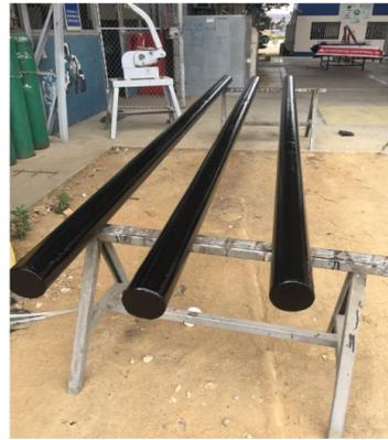
**Figura 4:** postes metálicos (4metros de alto x 4 " espesor 5mm)
