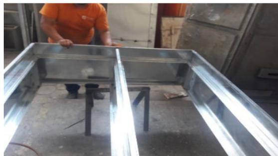
Figura 2.-Construcción de gabinete eléctrico..
