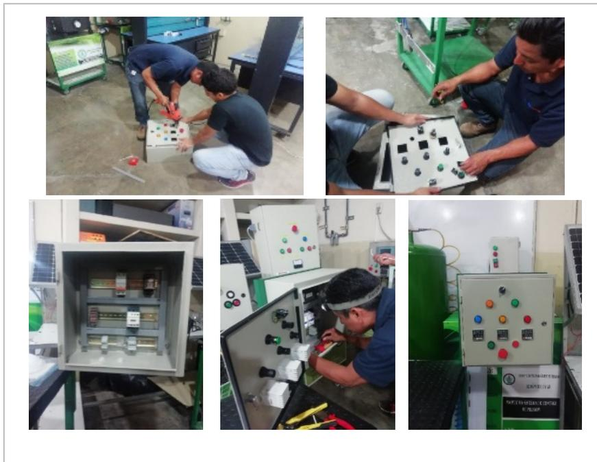
**Figura 12, 13, 14:** Perforaciones para la colocación de los respectivos elementos
