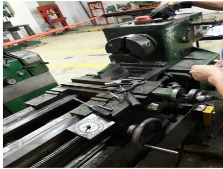
**Figura 3A:** Desmontaje de carro trasversal y charriot
