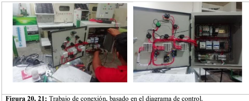
**Figura 20, 21:** Trabajo de conexión, basado en el diagrama de control.
