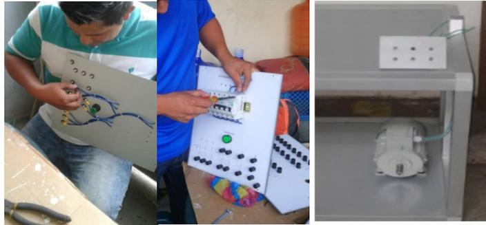
Figura 6. Cableado de los módulos y puesta del motor
