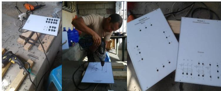
Figura 4. Perforación de los módulos
