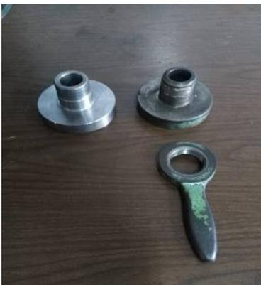
**Figura 4.** Pieza nueva, manivela de avance manual
